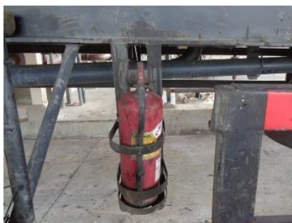
รูปที่ 2.2-16 ถังดับเพลิงประจำรถขนส่งน้ำมัน
